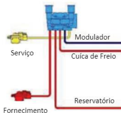
Figura 70: Esquema de fornecimento de ar
